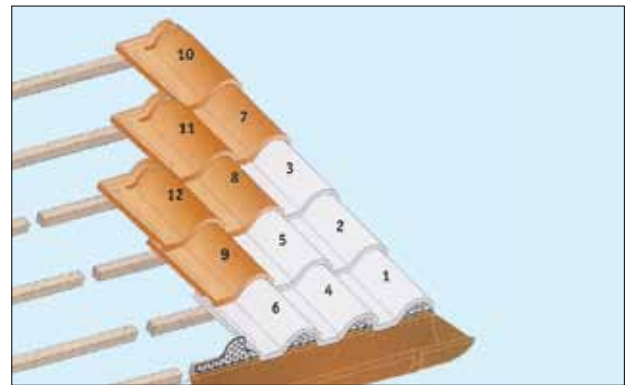
Sequenza di messa in opera di un manto di copertura in tegole portoghesi
